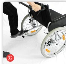
Die statische Stabilität beträgt beim Grundmodell  $5^\circ$  (ca. 8 %). Die kritische Hindernishöhe\* beträgt beim Grundmodell in ungünstiger Situation (max. Schwerpunktverlagerung nach hinten) 23 mm.
